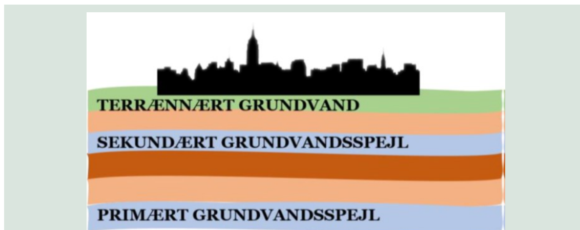
FIGUR 1. Konceptuel illustration af placering af det terrænnære grundvand i forhold til hhv. det sekundære og primære grundvandsspejl 2
