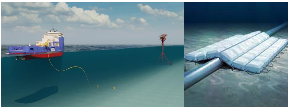
Figur 18-5. Illustration af offloadingsystemet og betonmadrasser.
