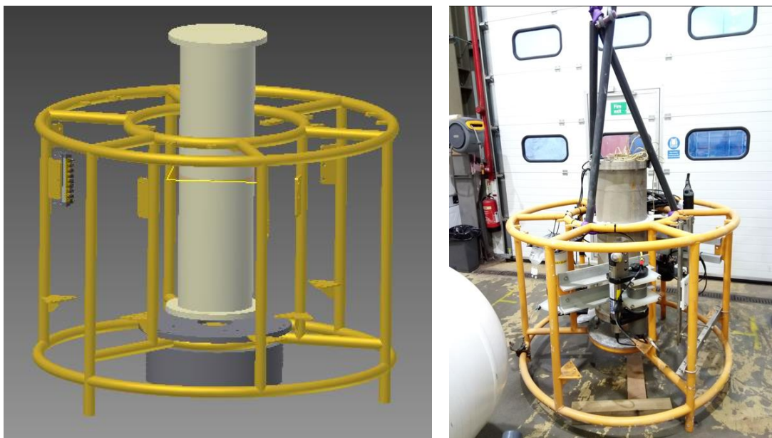
Figur 5-22 Skitse over landerens design (venstre) og et billede af lander med sensorer (højre). Det centrale hvide rør indeholder batteriet.
