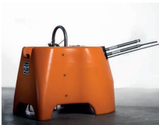
Figur 5-20 "NAMMU" havbundsstation (OBS) til overvågning af seismicitet.
