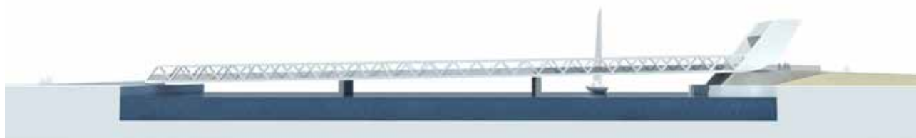
Figur 2.8 Klapbroen er ca. 130 meter lang og ca. 5 meter høj.
