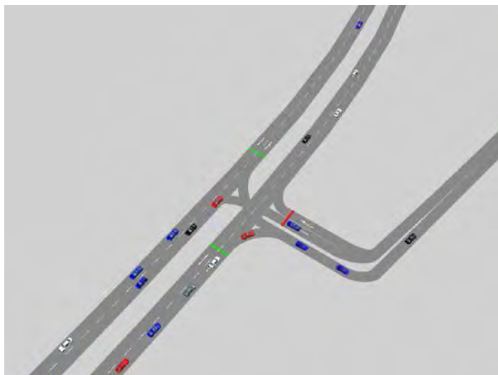
Figur 7.4 Billede fra trafiksimulering af det signalregulerede kryds på omfartsvejen ved Plantagevej i forslag B. Trafikafviklingen i krydset er robust, og ventetider i krydset vil kunne reduceres yderligt ved at etablere separate højre- og venstresvingsbaner på omfartsvejen.
