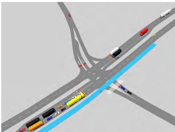
Figur 7.4 Billede fra trafiksimulering af det signalregulerede kryds på omfartsvejen ved Plantagevej i forslag B. Trafikafviklingen i krydset er robust, og ventetider i krydset vil kunne reduceres yderligt ved at etablere separate højre- og venstresvingsbaner på omfartsvejen.
