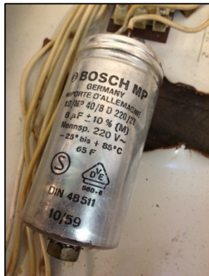
Eksempler på påtryk på kondensatorer
