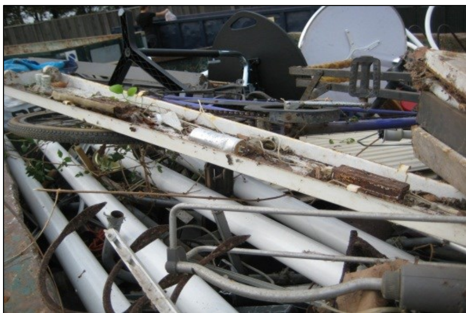
Lysstofarmatur med kondensator i container med blandet metalaffald. Ved brud på kondensatoren kan denne opbevaring give anledning af forurening af andet metalaffald og omgivelserne.
