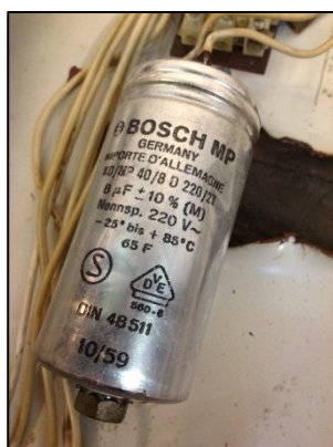
Eksempler på påtryk af kondensatorer
