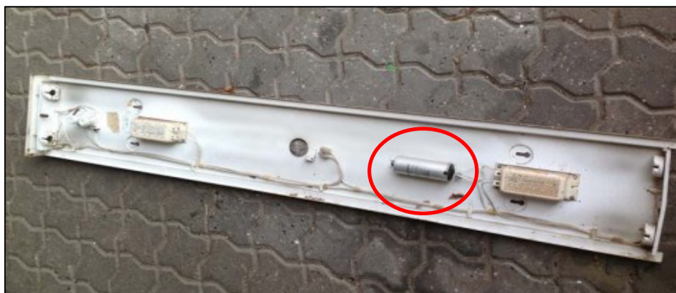
Lysstofarmatur med kondensator (rød cirkel)
